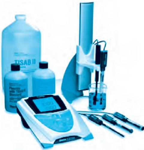
การวัดค่าความเป็นกรด-เบส เป็นรายการทดสอบที่มีบทบาทสำคัญในการควบคุมคุณภาพของผลิตภัณฑ์หลายประเภท เช่น ผลิตภัณฑ์ทำความสะอาด เครื่องสำอาง ผลิตภัณฑ์ยา เป็นต้น นอกจากนี้ยังมีบทบาทต่อการควบคุมคุณภาพด้านสิ่งแวดล้อม ซึ่งมีการกำหนดค่ามาตรฐานเกณฑ์ควบคุมรายการค่าความเป็นกรด-เบสของน้ำจากแหล่งต่าง ๆ ไว้อย่างชัดเจน
