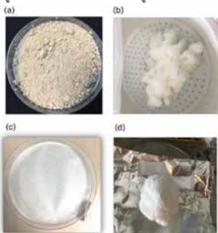
รูปที่ 4 ลักษณะของชานอ้อยบดก่อนการปรับสภาพ (a) ชานอ้อยหลังทำการปรับสภาพกระบวนการทางเคมี (b) ชานอ้อยหลังทำการปรับสภาพกระบวนการทางเคมีที่นำไปอบแห้งที่อุณหภูมิ 60 องศาเซลเซียส (c) เซลลูโลสทางการค้า (Microcrystalline cellulose) (d)
