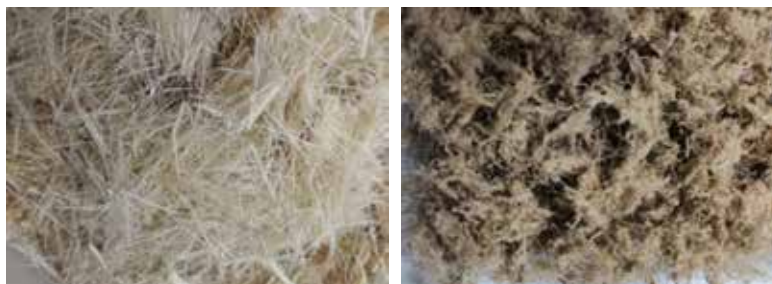
รูปที่ 4 เส้นใยใบสับปะรดก่อน (ซ้าย) และภายหลังการดัดแปร (ขวา)
