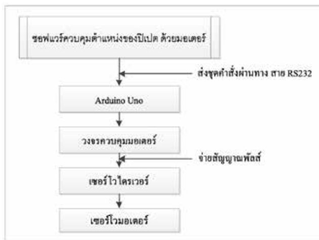
รูปที่ 6 แสดงการควบคุมตำแหน่งของปิเปตต์ด้วยมอเตอร์
