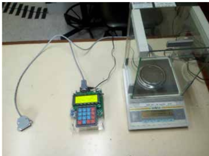
รูปที่ 13 การเชื่อมต่อระบบควบคุมการทำงานเข้ากับเครื่องชั่งและการตั้งค่าเงื่อนไขการเปลี่ยนแปลงของอุณหภูมิและเวลา
