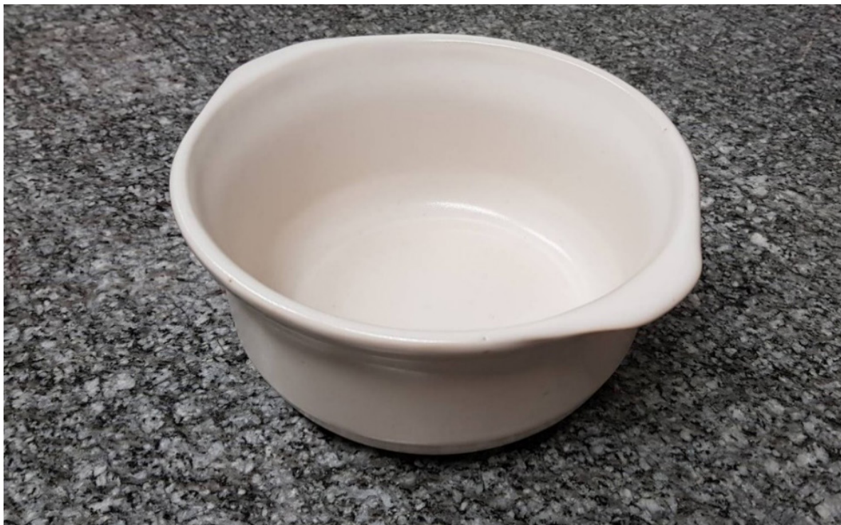
รูปที่ 6 : ผลิตภัณฑ์ตัวอย่างหลังเคลือบสูตรเคลือบ Pe.8 หลังเผาที่ อุณหภูมิ 1275 องศาเซลเซียส
