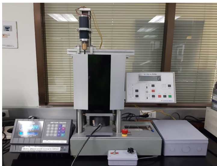
รูปที่ 9 : การติดตั้งอุปกรณ์ต้นแบบที่ช่วยควบคุมแรงที่กดเข้ากับเครื่องทดสอบกระดาษ
