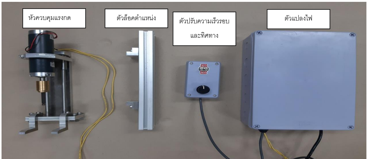
รูปที่ 8 : อุปกรณ์ต้นแบบที่ช่วยควบคุมแรงที่กดต่อเครื่องทดสอบกระดาษ
