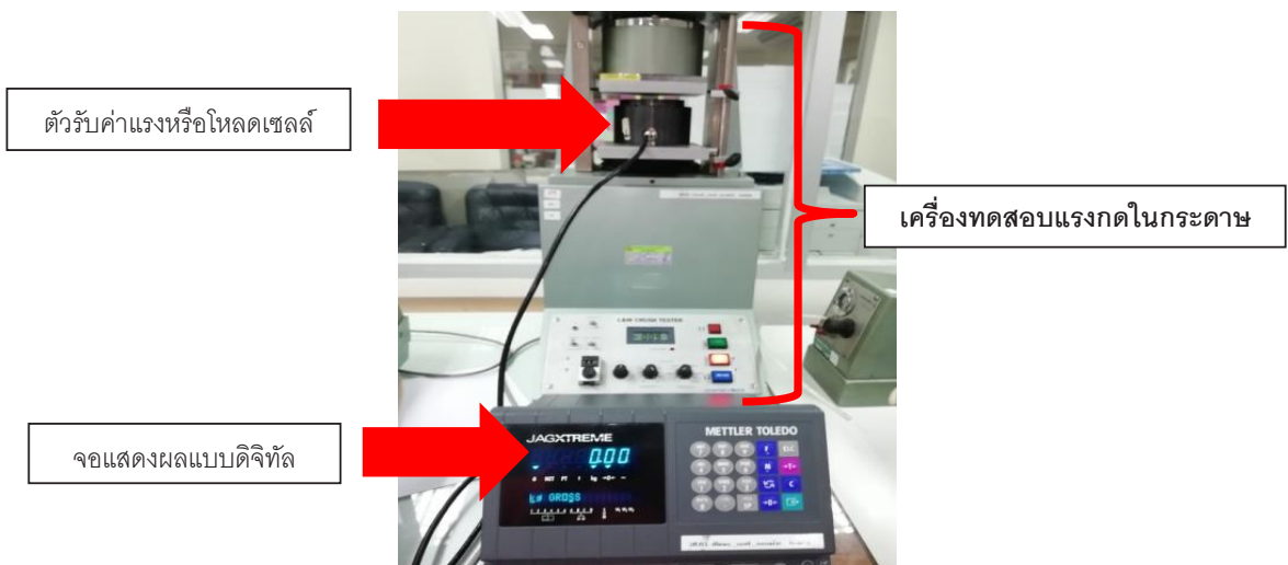
รูปที่ 4 : การสอบเทียบเครื่องวัดแรงกดวงแหวน
