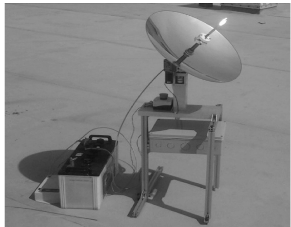
รูปที่ 2 แสดงภาพรวมของการทำงานระบบติดตามการเคลื่อนที่ของดวงอาทิตย์ที่พัฒนาขึ้น
