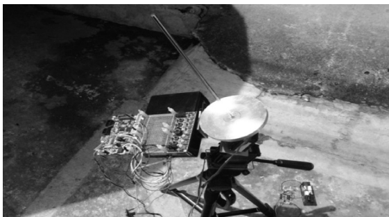
รูปที่ 1 แสดงเครื่องมือในการวัดมุมกวาดและมุมเงยตำแหน่งดวงอาทิตย์ เพื่อใช้ในการตรวจสอบความแม่นยำของสมการคำนวณตำแหน่งของดวงอาทิตย์ที่ใช้ในงานวิจัย (ก) คือ อุปกรณ์ใช้วัดดวงอาทิตย์ และ (ข) คือ แท่นวัดมุมกวาดและมุมเงย
