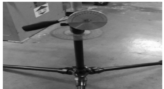
รูปที่ 1 แสดงเครื่องมือในการวัดมุมกวาดและมุมเงยตำแหน่งดวงอาทิตย์ เพื่อใช้ในการตรวจสอบความแม่นยำของสมการคำนวณตำแหน่งของดวงอาทิตย์ที่ใช้ในงานวิจัย (ก) คือ อุปกรณ์ใช้วัดดวงอาทิตย์ และ (ข) คือ แท่นวัดมุมกวาดและมุมเงย
