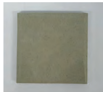
รูปที่ 3 แผ่นรองเผาคอร์เดียไรต์เผาที่อุณหภูมิ 1300 °C
