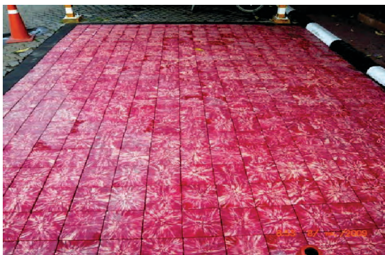
รูปที่ 3 การทดสอบสมบัติต่างๆ ของพื้นผิวผลิตภัณฑ์หมวกยางสำหรับคลุมบล็อกคอนกรีต
