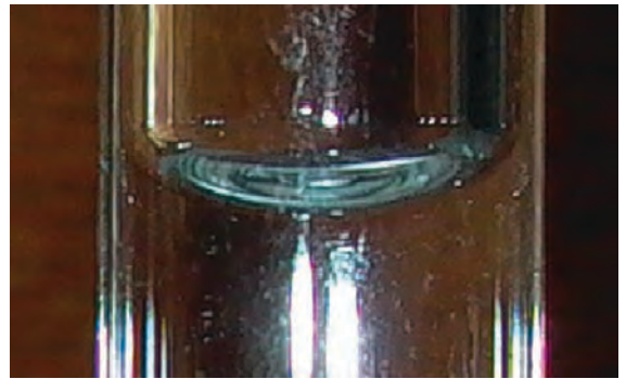
รูปที่ 1 แสดงเมนิสคัสและมุมที่ของเหลวสัมผัสข้างหลอดแก้ว (contact angle) ซึ่งเกิดจากแรงดึงดูดระหว่างของเหลวและแก้ว
