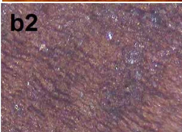
รูปที่ 1 (a1) พื้นผิวของหนังวัวผ่าน Profile Projector กำลังขยาย 5 เท่า (a2) พื้นผิวของหนังวัวผ่านกล้องจุลทรรศน์ที่กำลังขยาย 10 เท่า (b1) พื้นผิวของหนังจระเข้ผ่าน Profile Projector กำลังขยาย 5 เท่า (b2) พื้นผิวของหนังจระเข้ผ่านกล้องจุลทรรศน์ที่กำลังขยาย 10 เท่า
