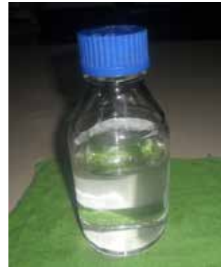
รูปที่ 8 กลีเซอรอลหลังจากผ่านกระบวนการทำให้บริสุทธิ์ ด้วยคอลัมน์โครมาโทกราฟี
