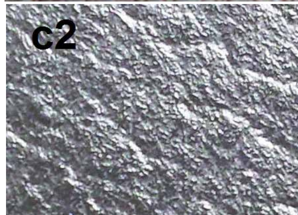
รูปที่ 2 (c1) พื้นผิวของหนังพอลิไวนิลคลอไรด์ ผ่าน Profile Projector ที่กำลังขยาย 5 เท่า (c2) พื้นผิวของหนังพอลิยูรีเทน ผ่าน Profile Projector กำลังขยาย 5 เท่า
