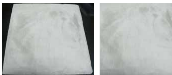
ชิ้นทดสอบและพื้นผิวของวัสดุตกแต่งประเภทปูนซีเมนต์ที่ไม่ได้ผสมเยื่อจากเศษกระดาษ
