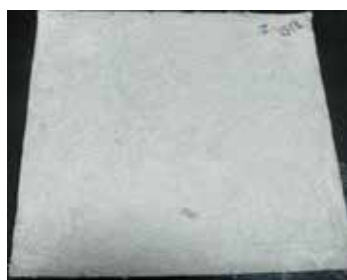
ชิ้นทดสอบและพื้นผิวของวัสดุตกแต่งประเภทปูนซีเมนต์ที่ผสมเยื่อจากเศษกระดาษพิมพ์เขียน
