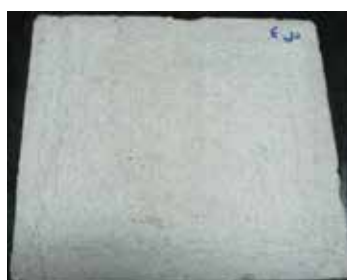
ชิ้นทดสอบและพื้นผิวของวัสดุตกแต่งประเภทปูนซีเมนต์ที่ผสมเยื่อจากเศษกระดาษผสม
