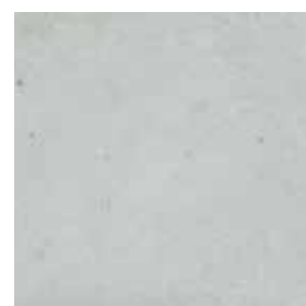
ชิ้นทดสอบและพื้นผิวของวัสดุตกแต่งประเภทปูนซีเมนต์ที่ผสมเยื่อจากเศษกล่องกระดาษ
