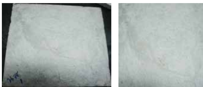
ชิ้นทดสอบและพื้นผิวของวัสดุตกแต่งประเภทปูนซีเมนต์ที่ผสมเยื่อจากเศษกระดาษหนังสือพิมพ์
