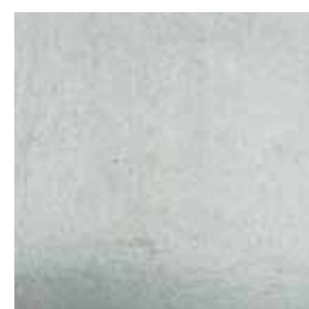
ชิ้นทดสอบและพื้นผิวของวัสดุตกแต่งประเภทปูนซีเมนต์ที่ผสมเยื่อจากเศษกระดาษผสม
