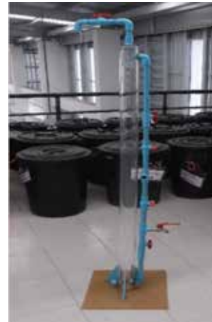
รูปที่ 3 ท่อกรองเส้นผ่าศูนย์กลาง 2.5 นิ้ว ความสูง 150 เซนติเมตร
