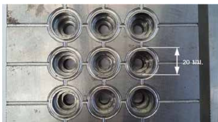
รูปที่ 3 แม่พิมพ์ที่ใช้ในการศึกษาทดลองทำด้วยเหล็ก P20 ขนาด 9 หลุม
