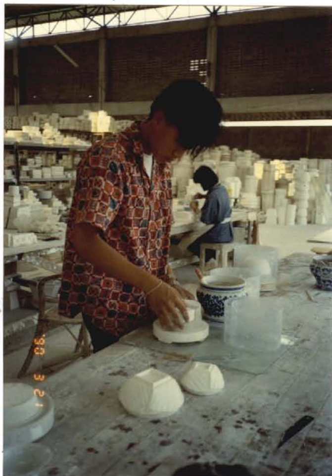
การทำแม่แบบพิมพ์ปูนปลาสเตอร์
