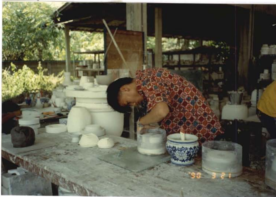
การทำแม่แบบพิมพ์ปูนปลาสเตอร์
