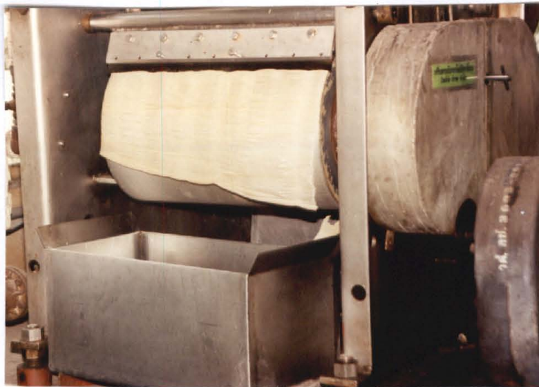
ภาพที่ 4 ธัญพืชแผ่นกรอบ ซึ่งผลิตโดยผ่านส่วนผสมเข้าเครื่องทำอาหารแห้งแบบลูกกลิ้ง (Drum dryer)
