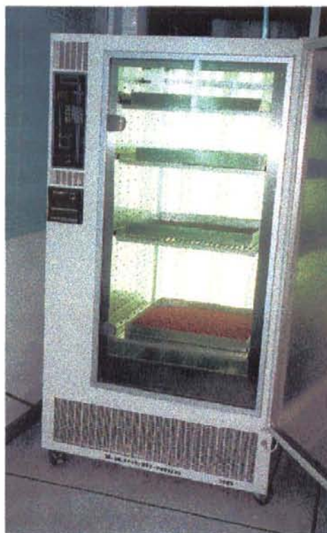
ภาพที่ 13 การหมักข้าวแดงในตู้อบเพาะเชื้อชนิดควบคุมอุณหภูมิและความชื้น (climatic cabinet รุ่น KBP 6395 FL. เครื่องหมายการค้า Termaks นอร์เวย์)
