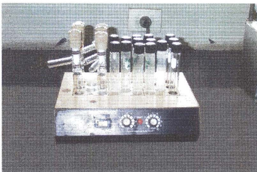
รูปที่ 6 เครื่องให้ความร้อนชนิดหลุม (heating block)
