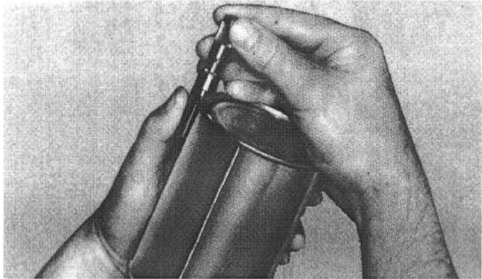
รูปที่ 18 การวัดความยาวของตะเข็บ(seam length)
