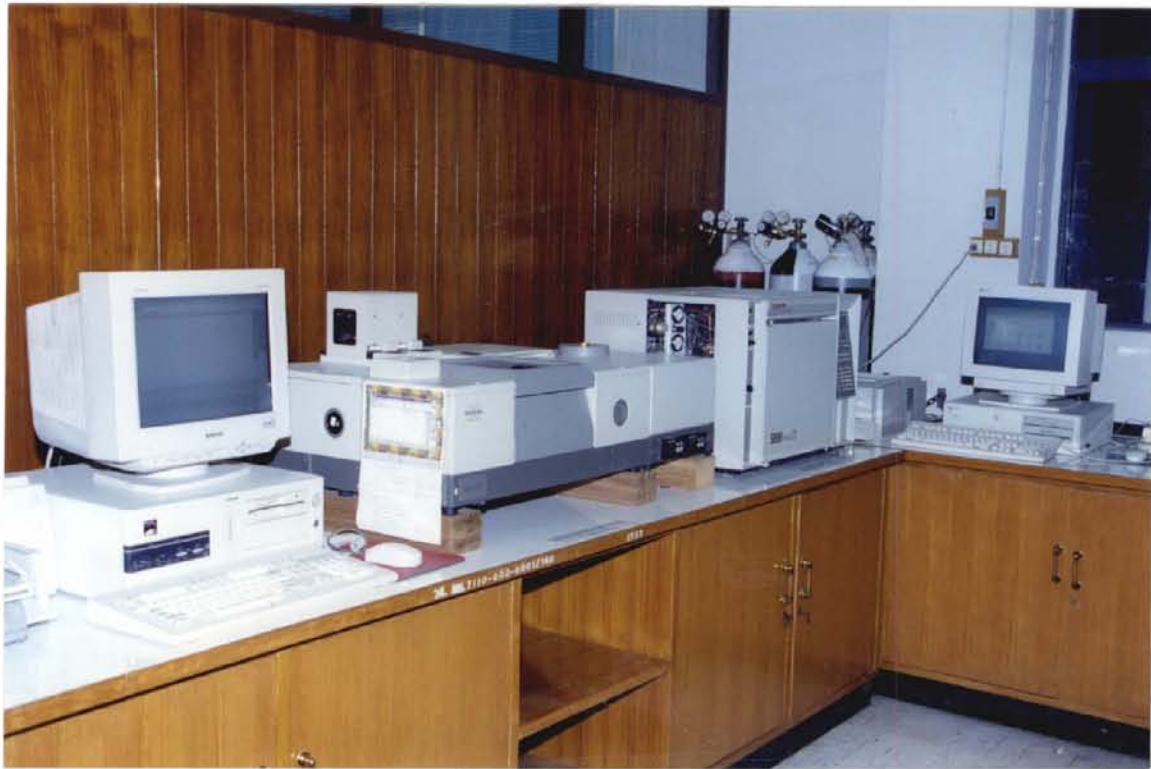
รูปที่ 56 เครื่องแก๊สโครมาโทกราฟี ฟลูออโรทรานส์ฟอร์มอินฟราเรดสเปกโตรมิเตอร์
