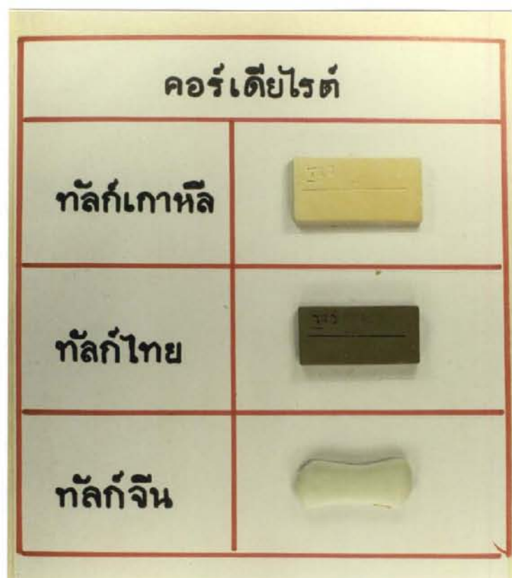
ภาพที่ 2.2 คอร์เดียวไรต์เตรียมจากทัลก์เกาหลี ไทย และจีน
