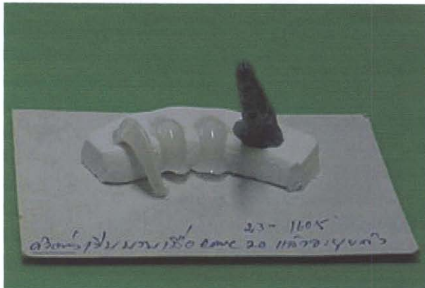
รูปที่ 7 การทดสอบความทนไฟเทียบกับโคนมาตรฐานเบอร์ 19, 20 และ 23
