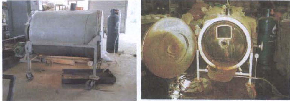
รูปที่ 2.3 เครื่องผลิตสารกรองสนิมเหล็กระดับ Pilot plant เป็นถังทรงกระบอกแนวนอน ขนาด 200 ลิตร
