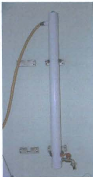
รูปที่ 2.4 เครื่องกรองน้ำ ขนาดเส้นผ่านศูนย์กลาง 3.8 เซนติเมตร
