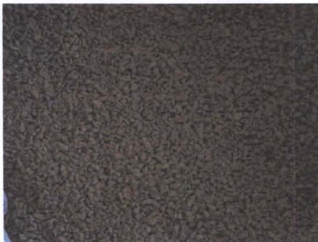
รูปที่ 3.1ข เม็ดดินเผาที่ผ่านตะแกรงขนาดเบอร์ 10 แต่ไม่ผ่านตะแกรงขนาดเบอร์ 30
