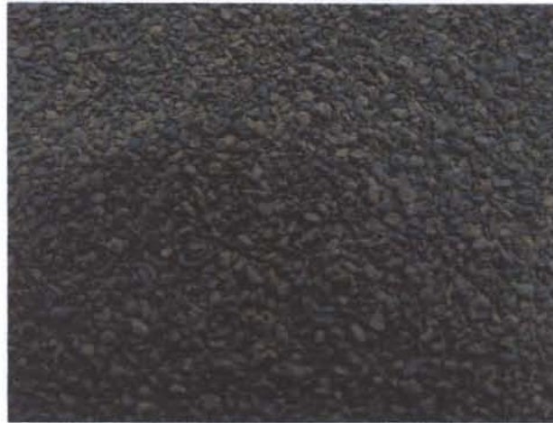
รูปที่ 3.2 สารกรองสนิมเหล็กที่ผลิตได้ด้วยเครื่องผลิตสารกรองสนิมเหล็กระดับ Pilot Plant
