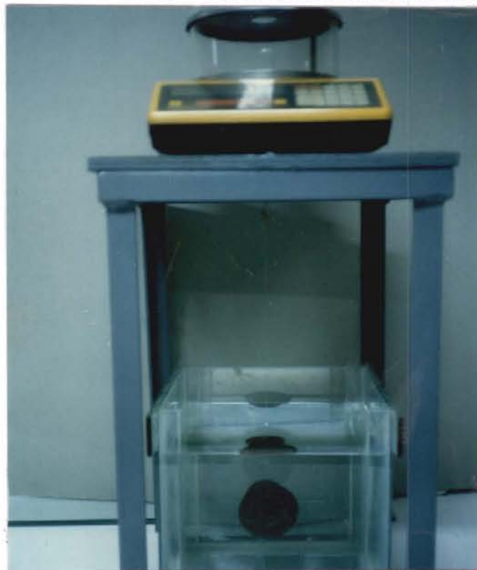
ภาพที่ 4 การทดลองหาค่าปริมาตรของตัวอย่างอะลูมิเนียมรูปทรงด้วยวิธีการชั่งในของเหลวที่อยู่นิ่ง ด้วยเทคนิคแบบใหม่
