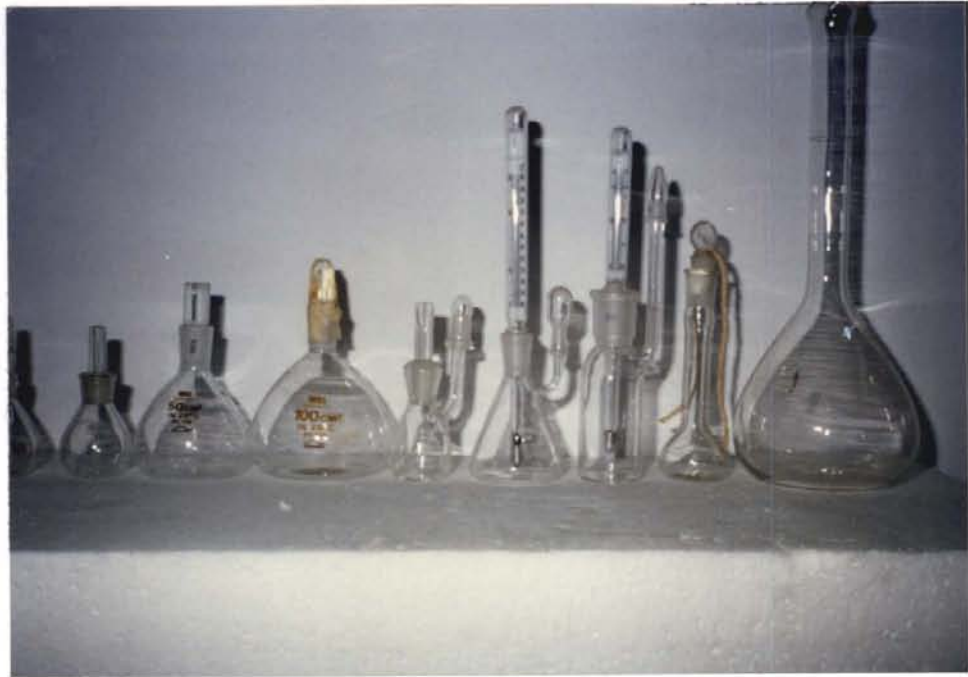
ภาพที่ 1 แสดงลักษณะและขนาดของขวดปิกนอมิเตอร์แบบต่างๆ
