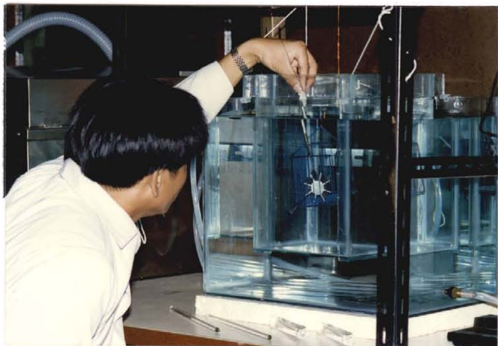
ภาพที่ 10 การทดลองซึ่งอะลิมิเนียมรูปพรรณในของเหลวที่นิ่งโดยทำการปรับและควบคุมอุณหภูมิด้วยเทคนิคและอุปกรณ์ที่ได้วิจัยพัฒนาขึ้นใหม่
