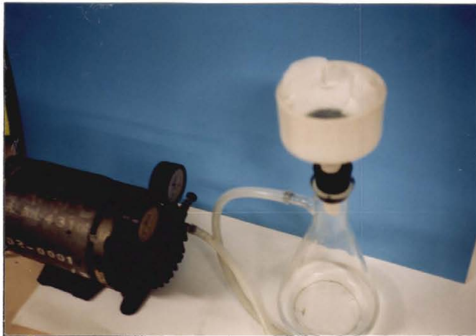
ภาพที่ 4 การล้างทำความสะอาดเกรนสารขัดผิวที่ได้หลังจากการแช่ตัวอย่างหินเจียรในกรดไฮโดรฟลูออริกโดยใช้ Filtering suction flask
