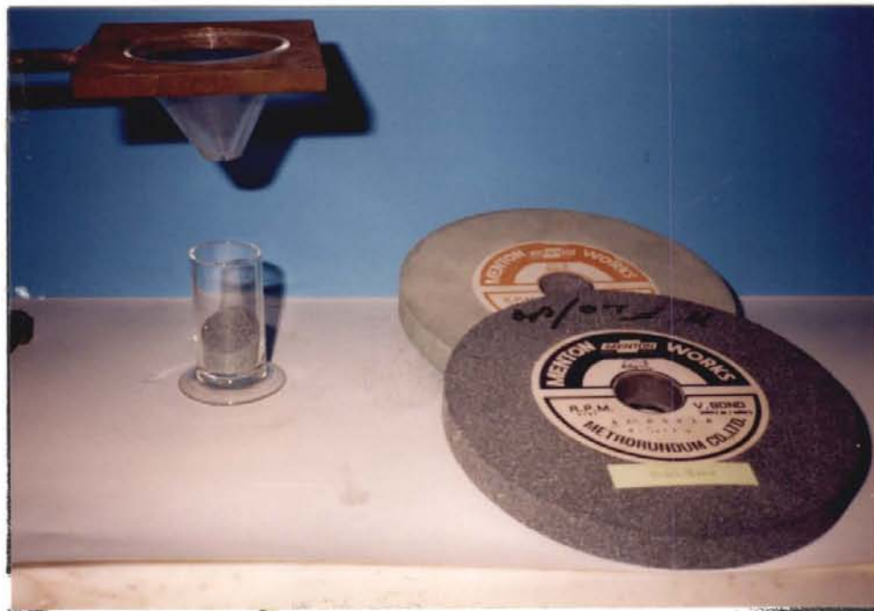
ภาพที่ 5 ลักษณะอุปกรณ์และการทดสอบหาค่าความหนาแน่นบัลด์ซ์ของ เกรนสารขัดผิว
