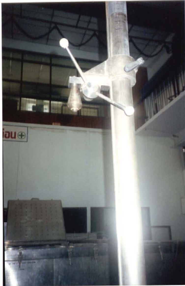
รูปที่ 11 แสดงภาพถ่ายเครื่องมือทดสอบความต้านแรงกระแทกด้านข้าง
