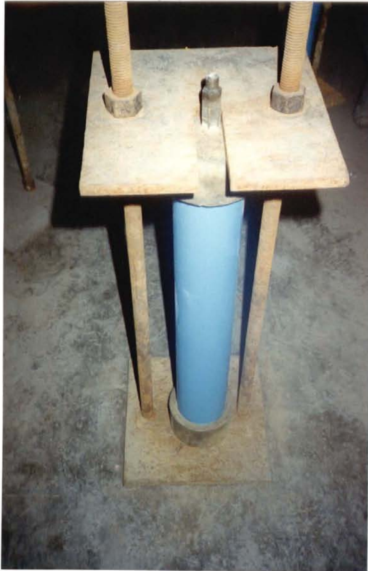
รูปที่ 32 ภาพถ่ายแสดงการประกอบท่อพีวีซีเข้ากับอุปกรณ์ยึดปลายท่อและอุปกรณ์ สำหรับยึดท่อพีวีซี
