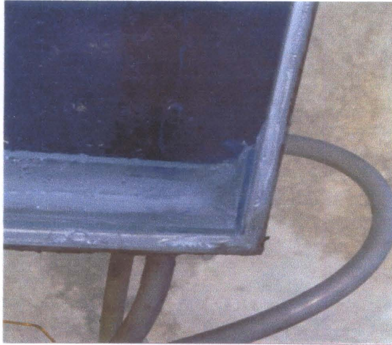
ภาพที่12 ลักษณะของรางรับก้นน้ำรูปตัว"วี"ของเครื่องกลั่นน้ำแบบ3 เมื่อมองจากด้านบน
