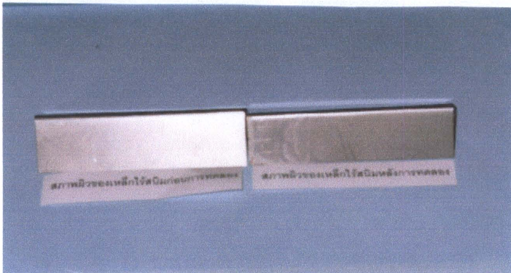
ภาพที่ 9 ลักษณะของสภาพผิวของตัวอย่างแผ่นเหล็กไร้สนิมก่อนและหลังการทดลองแช่อยู่ในจี๊ด้า เกลบที่มีน้ำท่วมเต็มในบีกเกอร์ขนาดใหญ่ที่ถูกปิดด้วยกระจก แล้วถูกนำไปไว้ในตู้อบ ที่อุณหภูมิ 80 องศาเซลเซียสเป็นเวลานาน 10 วัน ซึ่งปรากฏว่าสภาพของผิวของตัวอย่าง แผ่นเหล็กไร้สนิมไม่มีการเปลี่ยนแปลงไปจากเดิม
