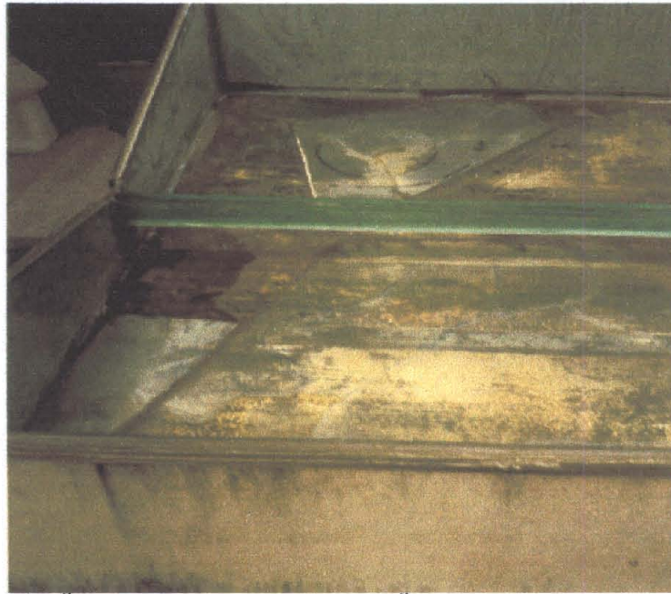
ภาพที่ 4 เครื่องกักน้ำด้วยพลังงานแสงแดดที่กระจกพื้นแตกชำรุดเสียหายเนื่องจากการขยายตัวของกระจกเมื่อน้ำคืบภายในเครื่องกักน้ำแห้งลง
