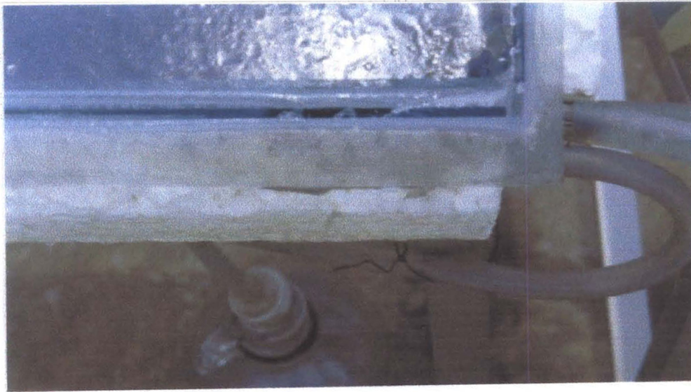
ภาพที่ 6 ลักษณะของรางรับน้ำกลั่นรูปตัว”ยู”ในเครื่องกลั่นน้ำด้วยพลังงานแสงแดดแบบ 2 เมื่อมองจากด้านบนจะเห็นว่ารางเป็นร่องแคบ โดยมีท่อน้ำกลั่นและท่อน้ำดิบอยู่ทางด้านข้าง
