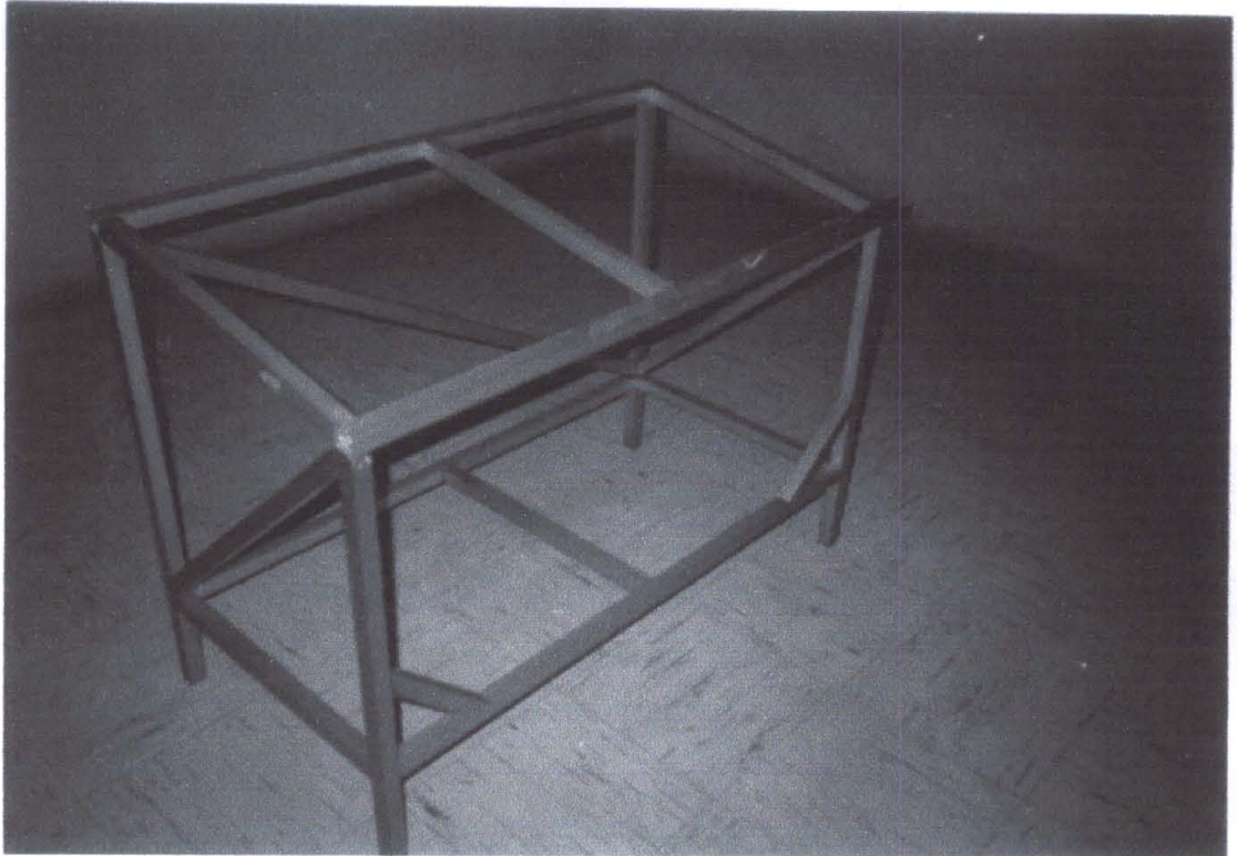
ภาพที่ 14 ฐานวางเครื่องกลั่นน้ำด้วยพลังงานแสงแดดที่ออกแบบขึ้นใหม่โดยทำจากอะลูมิเนียมกล่องชุบผิวด้วยไฟฟ้าขนาด 2.5 X 2.5 ซม.หนา 1 มม.
