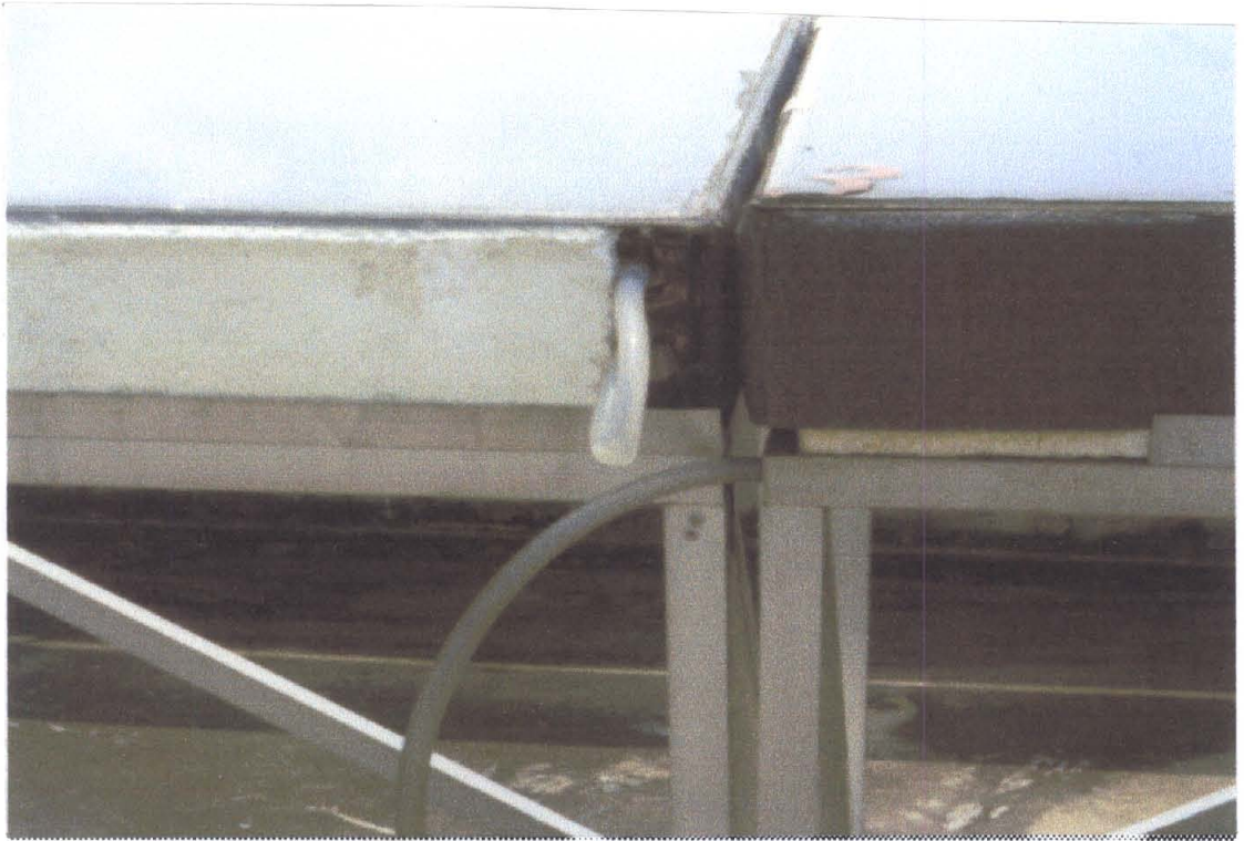
ภาพที่ 10 ลักษณะตำแหน่งของท่อน้ำกลั่นที่ออกแบบให้อยู่ด้านหน้าของเครื่องกลั่นน้ำแบบปรับปรุง ทำให้สามารถวางเครื่องกลั่นน้ำให้ติดชิดกันได้ จะทำให้ลดพื้นที่ที่ต้องใช้ในการติดตั้ง และมองดูสวยงามกว่าเครื่องกลั่นน้ำแบบ 2
