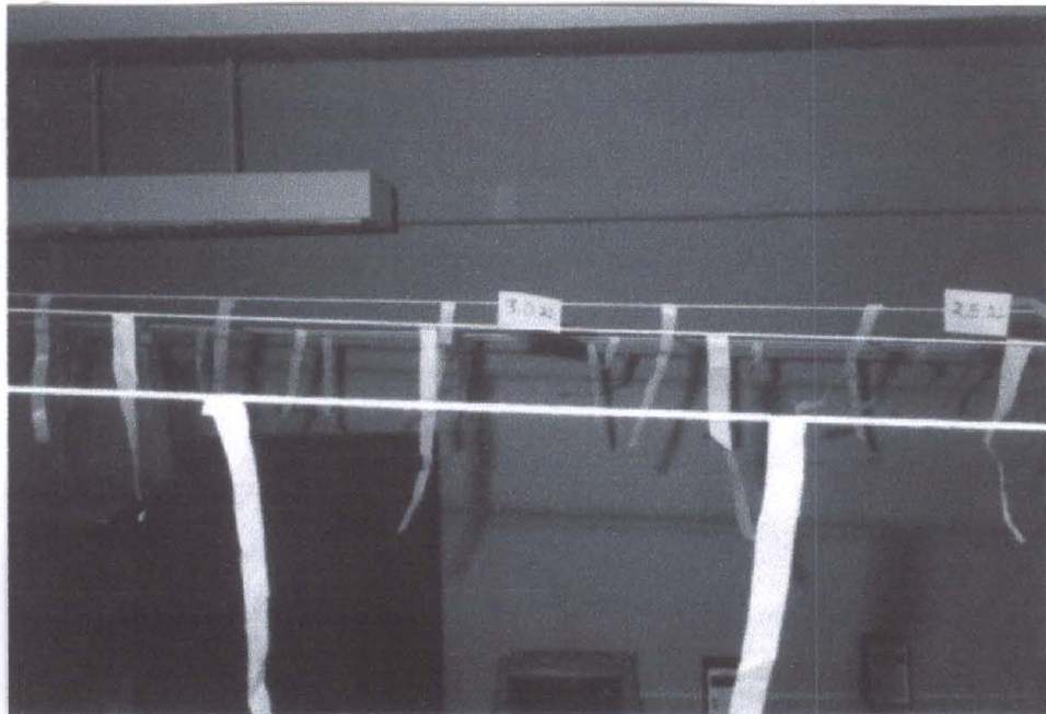
ภาพที่ 7 การศึกษาทดลองหาตำแหน่งและระยะทางที่กระแสมจากเครื่องปรับอากาศตกกระทบบริเวณแนวระนาบทิศขวางใต้เครื่องปรับอากาศ
