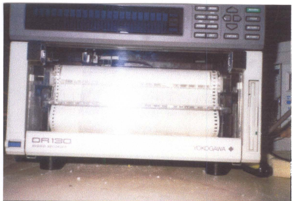
ภาพที่16 เครื่องไฮบริดมิเตอร์ใช้สำหรับแสดงและบันทึกค่าการวัดอุณหภูมิของอากาศในห้องปฏิบัติการได้พร้อมกันหลายๆจุดในเวลาเดียวกัน
