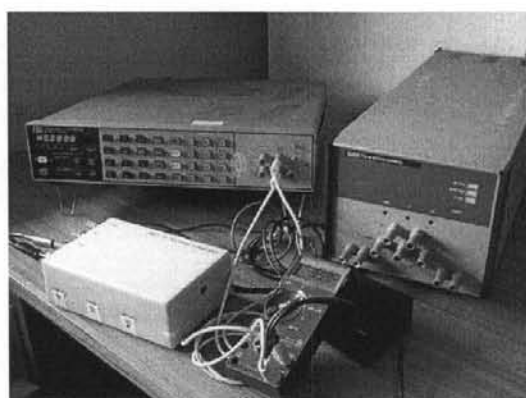
รูปที่ 3.2 การสอบเทียบดิจิตอลโวลต์มิเตอร์ด้วยชุดแรงดันไฟฟ้ามาตรฐานกับเครื่องAVSC
