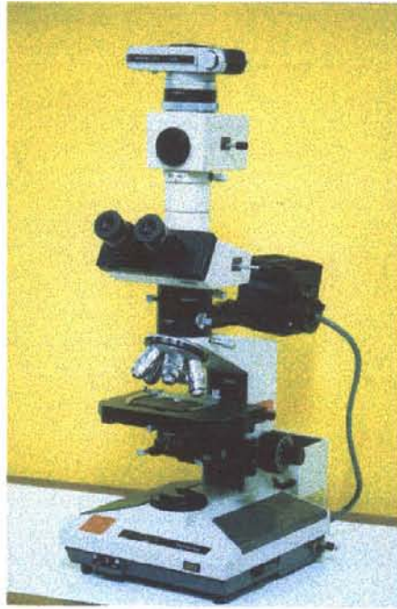
ภาพที่ ก-11 กล้องจุลทรรศน์สำหรับวัดความหนาผิวชุบด้วยวิธีภาคตัดขวาง (Microscopic cross-section) OPTICAL MICROSCOPE
