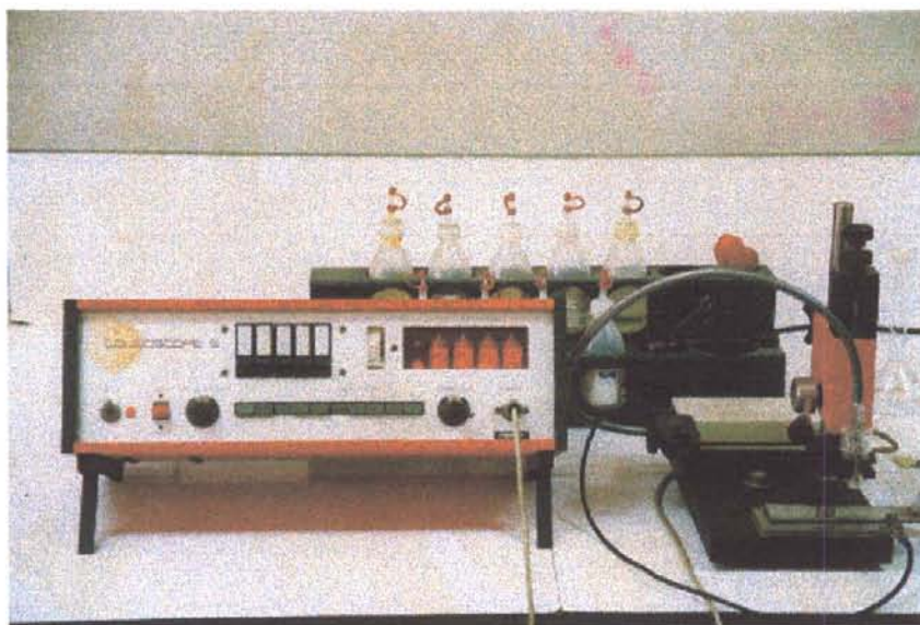
ภาพที่ ก-10 เครื่องวัดความหนาผิวชุบด้วยวิธีกระแสไฟฟ้าและน้ำยาอิเล็กโตรไลท์ (Couloscope method) ยี่ห้อ FISCHER รุ่น COULOSCOPE S 8
