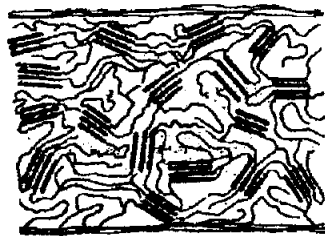
รูปที่ 5 แสดงการจัดเรียงตัวของโพลิเมอร์แบบเป็นผลึกเป็นบางส่วน
