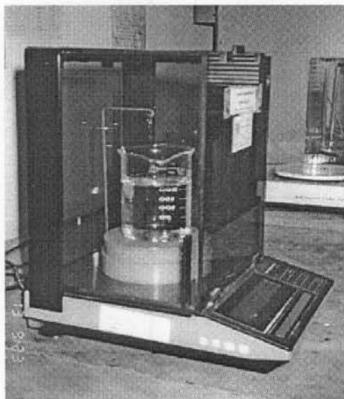
รูปที่ 2-3 ชั่งน้ำหนักตัวอย่างพลาสติกบวกกับเส้นลวดและตัวถ่วงน้ำหนักเพื่อหาความถ่วงจำเพาะ
