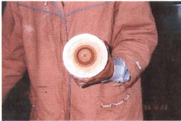
รูปที่ 13 แสดงกระถางหญ้าแฝกที่ขึ้นรูปแล้ว (สีแดง) อยู่ในโมลด์ปูนพลาสติก (สีขาว)
