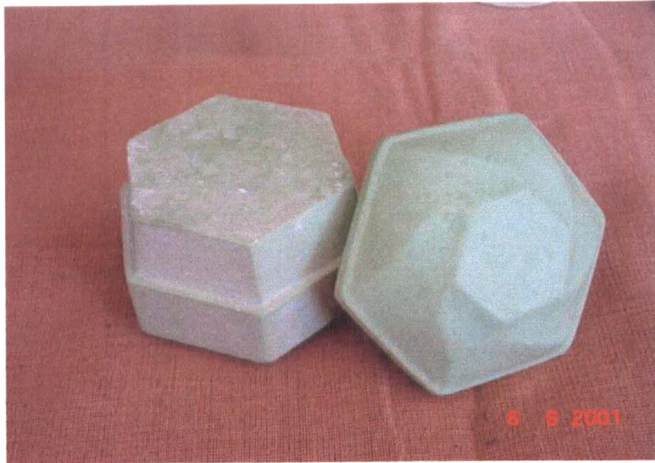
รูปที่ 5 แสดงรูปถ่ายแบบแม่พิมพ์ที่ทำด้วยปูนปลาสเตอร์ชนิดแอลฟา
