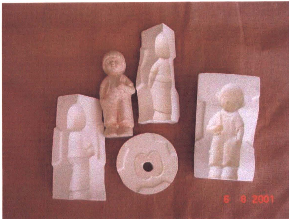
รูปที่ 6 แสดงรูปถ่ายแบบแม่พิมพ์ที่ทำด้วยปูนปลาสเตอร์ชนิดบีตา
