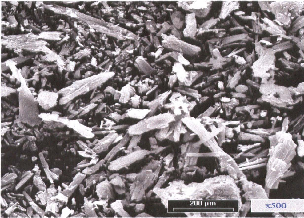
รูปที่ 3 แสดงรูปถ่ายของปูนพลาสติกที่ผลิตได้ด้วย Scanning electron microscope
