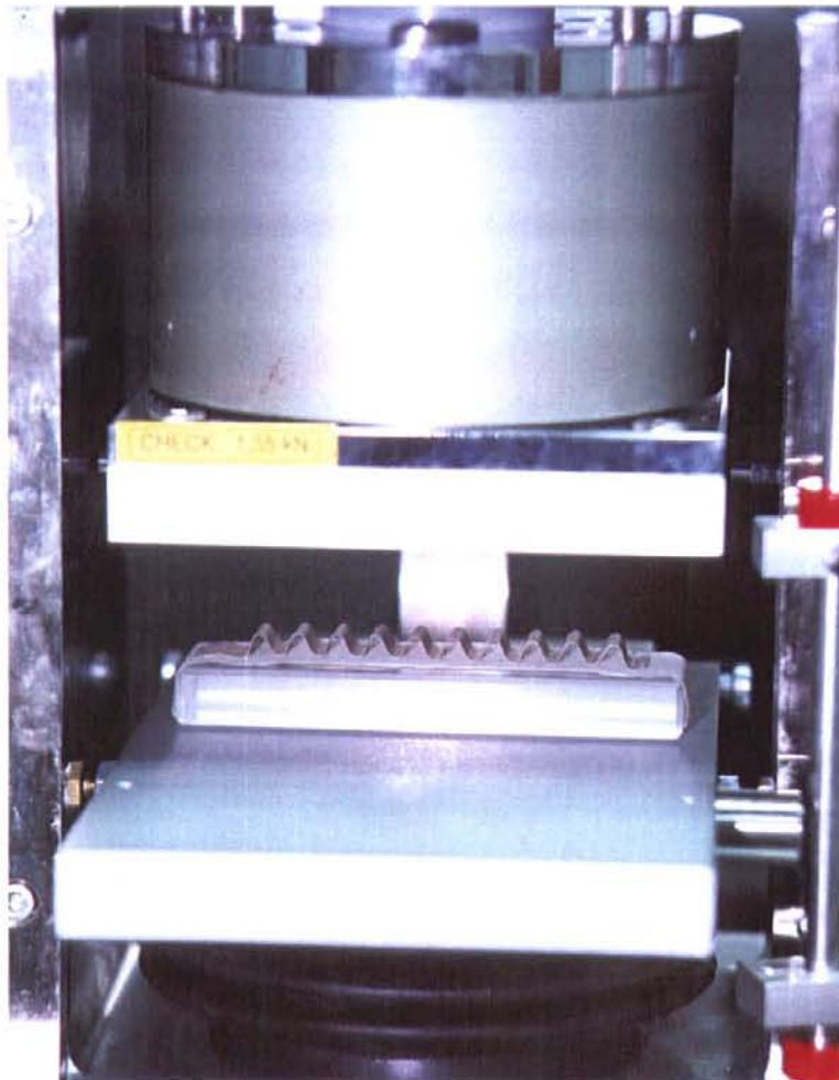
ภาพที่ 8 แสดงการทดสอบความต้านแรงกดลอนลูกฟูก
