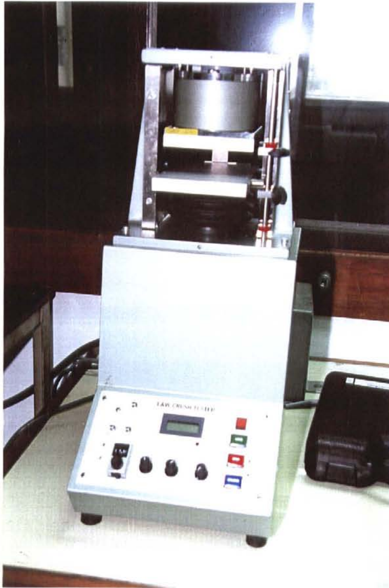
ภาพที่ 2 เครื่องทดสอบแรงกดชนิดแทนกดล่างเคลื่อนที่กดขึ้นทดสอบด้วยความเร็วคงที่
