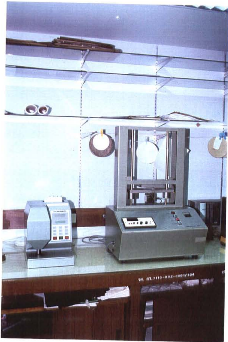
ภาพที่ 1 เครื่องทดสอบแรงกดชนิดแท่นกดบนเคลื่อนที่กดขึ้นทดสอบด้วยความเร็วคงที่
