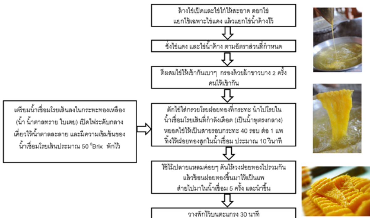
รูปที่ 1 แผนภูมิกระบวนการผลิตฝอยทองสด
