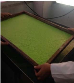
รูปที่ 3 แสดงการขึ้นแผ่นกระดาษจากเศษผ้าฝ้ายแบบหัตถกรรมและตกแต่งลวดลายในห้องปฏิบัติการ
