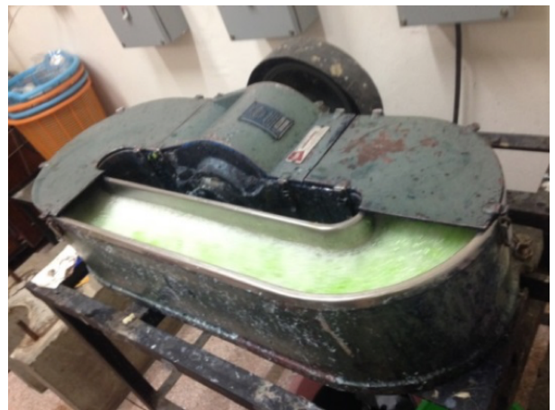
รูปที่ 1 แสดงการบดเยื่อผ้าฝ้ายด้วยเครื่องบดเยื่อแบบ Valley beater
