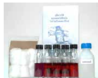
รูปที่ 1 ชุดทดสอบโคลิฟอร์มที่กรมวิทยาศาสตร์บริการพัฒนา
