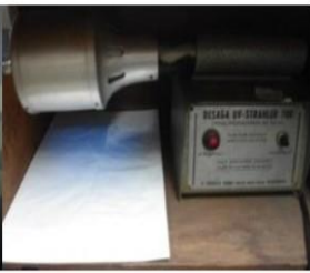
ภาพตัวอย่าง2 กระดาษทิชชูที่ไม่มีการเติมสารฟอกขาวเมื่อทดสอบ เมื่อทดสอบจะไม่พบสารเรืองแสง
