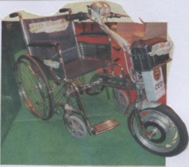
กว่าบาทมาตัดแปลง โดยตั้งเอาเฉพาะส่วนหน้าของรถมาออกแบบโครงสร้างใหม่ สำหรับนำไปประกอบเข็นคนพิการที่มืออยู่เดิม ทำให้รถเข็นมีขีดความสามารถเพิ่มขึ้นในการเคลื่อนที่ไปได้ทุกแห่งหนึ่งผ่านมา แม้กระทั่งคนพิการสามารถเคลื่อนที่ได้
