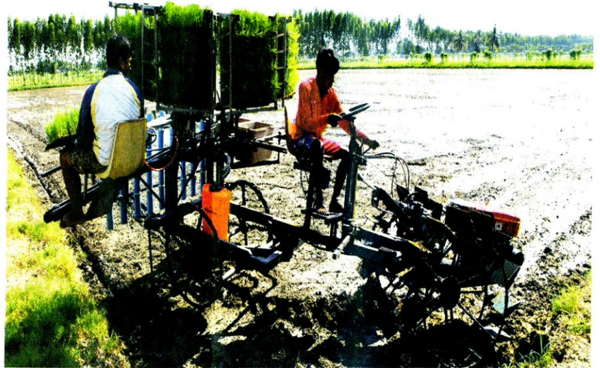
เครื่องจักรปลูกข้าวใช้เทคโนโลยีแรงจลนศาสตร์
