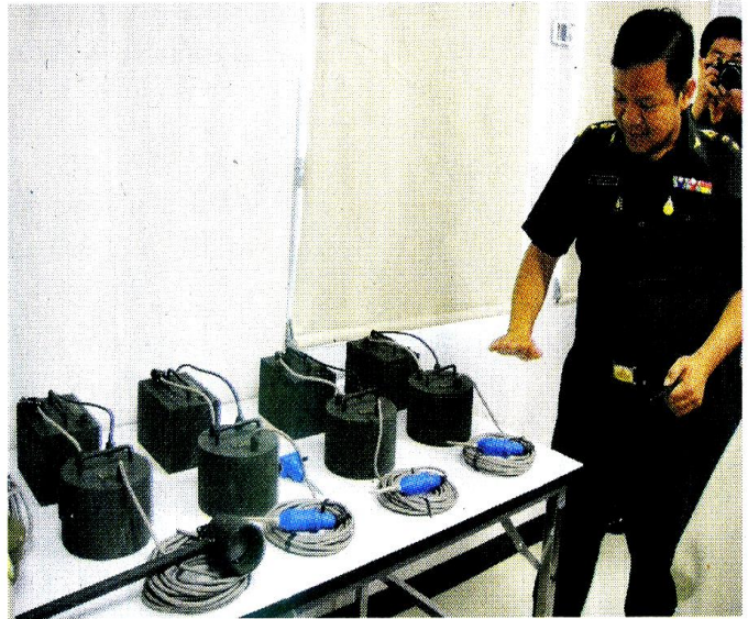
เครื่องมือเฝ้าตรวจพื้นที่ระยะไกล สำหรับเฝ้าตรวจและแจ้งเตือนการบุกรุกของบุคคลภายนอก
