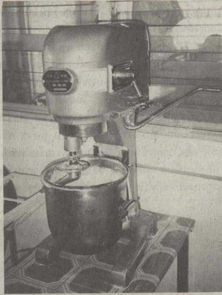
นำส่วนผสมต่างๆ กับเนื้อปลาใส่เข้าไปในเครื่องนวดอันนี้ ได้ไปส่งตามห้างก็จะนำไปแช่ในห้องเย็นที่เข้าไว้ที่ตลาดไท เพราะต้องผลิตไว้มากพอเพื่อเตรียมไว้ป้อนห้างต่างๆ”
