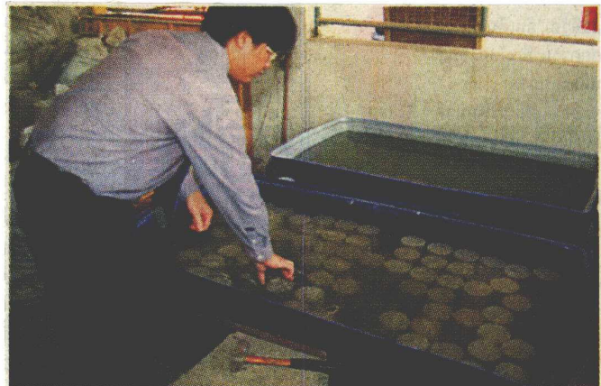
การทดลองคุณสมบัติการทนต่อกรดของคอนกรีตผสมถ้ำลอย
