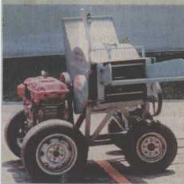
ขนาดความยาวระหว่าง 5 เมตรถึง 8.5 เมตร น้ำหนักระหว่าง 5 ถึง 15 กิโลกรัม พบบนเครื่องหันย่อยทางปาล์มน้ำมันที่พัฒนาขึ้นใหม่นี้สามารถหันทางปาล์มได้ทุกขนาด โดยใช้เครื่องยนต์ดีเซลขนาดไม่ต่ำกว่า 10 แรงม้าเป็นต้นก่าถึง มีอัตราการทำงานประมาณ 1,500-2,500
