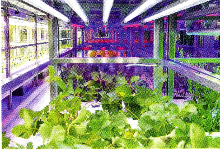
โรงงานผลิตพืชจะใช้เทคโนโลยีควบคุมสภาพแวดล้อมให้เหมาะสมกับชนิดของพืช
