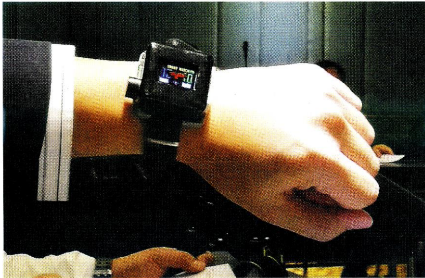
ต้นแบบนาฬิกาตรวจจับก๊าซพิษเพื่อความปลอดภัยของผู้ปฏิบัติงานในโรงงานอุตสาหกรรม
