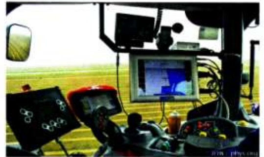
ทางเคอร์คิดตั้งอุปกรณ์จีโนมเชื่อมต่อกับเทคโนโลยีดาวเทียมสามารถควบคุมตำแหน่งการปลูกได้แม่นยำ
