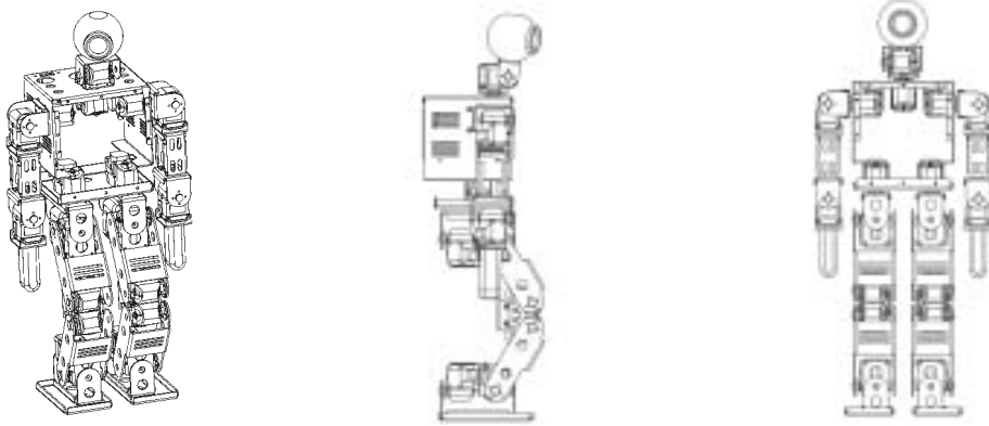
รูปที่ 5 : หุ่นยนต์ฮิวแมนอยด์ “พอดี้” มีจุดเด่นที่มีมอเตอร์ที่เข้า 2 ตัวเพื่อเพิ่มสมรรถนะในการเดินเร็ว
