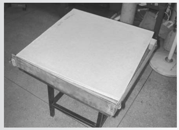
แผ่นยิปซัมเสริมเส้นใยธรรมชาติจากหญ้าแฝก ขนาด 600 x 600 x 9 มิลลิเมตร
