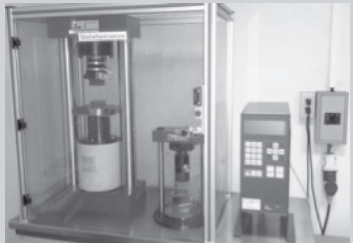
ภาพที่ 2 เครื่องทดสอบความต้านแรงอัดและแรงดัดของปูนซีเมนต์
