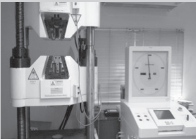
ภาพที่ 1 เครื่องทดสอบ Universal Testing Machine สำหรับทดสอบความต้านแรงดึงและความยืด
