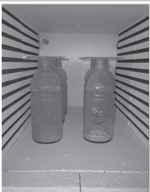
ภาพที่ 3 การทดลองการเพิ่มความทนทานต่อการกัดกร่อนผิวภายในขวดแก้วสำหรับเครื่องดื่ม
