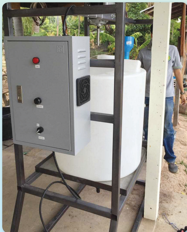
รูปที่ 3 ระบบบำบัดน้ำเสียโดยการตกตะกอนด้วยสารเคมี
