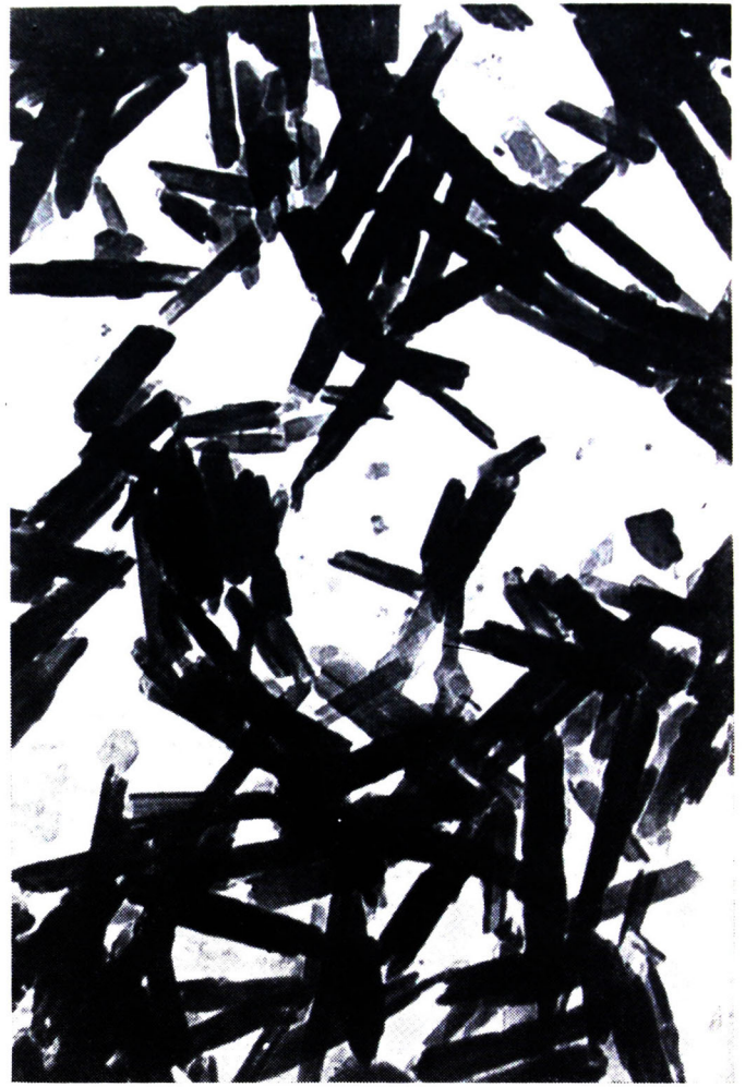
ผลึกดินขาวถ่ายจากกล้องจุลทรรศน์อิเล็กตรอน ขยาย ๒๕,๐๐๐ เท่า เกอลิไนท์ (Kaolinite) จากอำเภอบ้านนาสาร สุราษฎร์ธานี ฮอลลอยไซต์ต์ (Holloysite) จากอำเภอโพธาราม ราชบุรี
