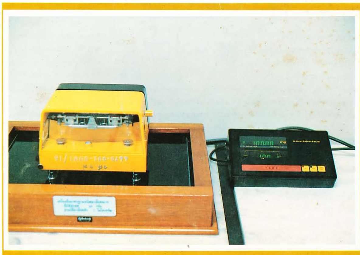
เครื่องชั่งมาตรฐานชนิดละเอียดมาก ชั่งได้สูงสุด 25 กรัม อ่านได้ละเอียดมากถึง 1 ไมโครกรัม
